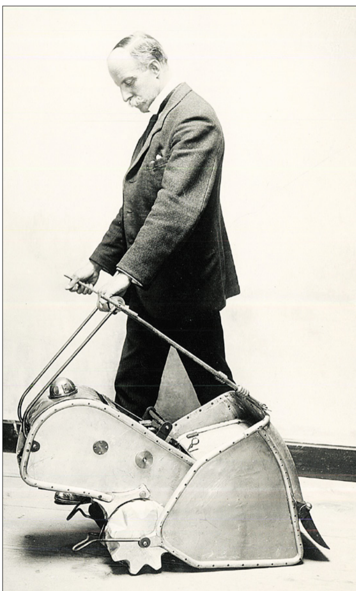
Konrad von Meyenburg mit dem Prototyp seiner Bodenfräse. Das Gerät sollte zu verschiedenen Arbeiten dienen.
